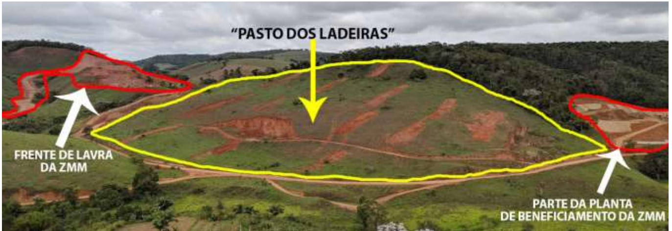
Figura 4 – Vista frontal e localização da área da nova frente de lavra em relação à planta 1 de beneficiamento e à frente de lavra licenciada da cava 01 do projeto.
